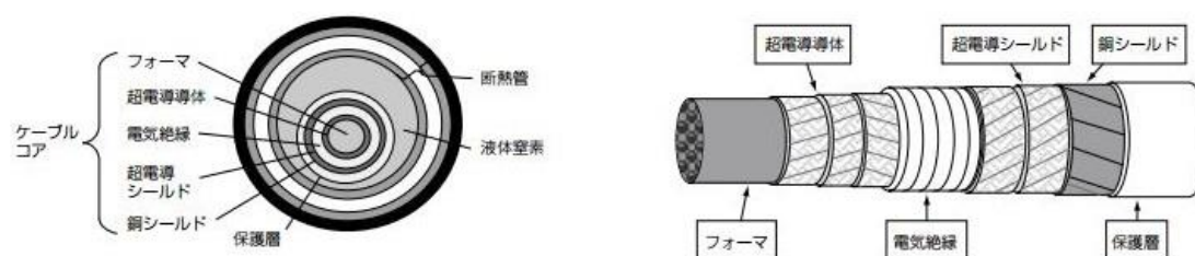
Fig. 1.5 同軸状超伝導電力ケーブルの模式図[1]
