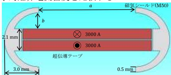
Fig. 1: テープ積層型ケーブルのモデル
