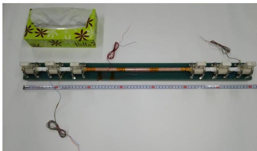
図 4.2:3 層縦磁界直流超伝導ケーブルの外観。
