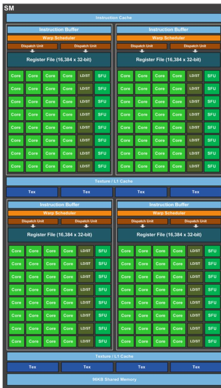
図 1.3. SM ブロックダイアグラム. 命令キャッシュ, テクスチャ/L1 キャッシュ 2 個 (テクスチャキャッシュと L1 キャッシュは領域を共有), テクスチャ・ユニット 8 個, 96 Kbyte シェアードメモリ及び 4 基の PB で構成される. PB は命令バッファ, Warp スケジューラ, 2 個のディスパッチユニット, レジスタファイル, CUDA コア 32 個, ロード/ストアユニット
