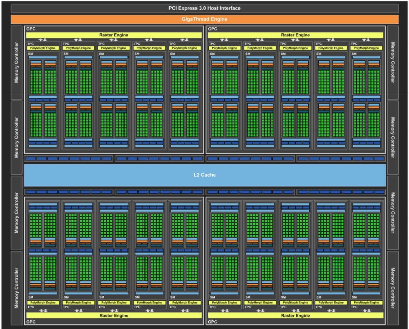
図 1.2. Pascal 世代 (GP104) GPU チップ概略図. 緑色の四角形で示された演算ユニットの CUDA コア 32 個, Warp スケジューラ, 2 命令発行の命令バッファ, SFU8 個をまとめて PB と呼ばれる実行単位として設けている. PB は 4 つを 1 組として SM を組織し, 各 SM にはテクスチャ・ユニットが置かれる. SM に PolyMorph エンジン (ジオメトリエンジン) をつないだものを TPC (Texture/Processor Cluster) とし, 5 基の TPC に Raster エンジンを併設したものを GPC (Graphics Processing Cluster) と呼ぶ. GP104 コアにはこの GPC が 4 基実装されており, 合計で 2,560 個の CUDA コアを擁する.
